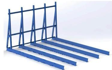
стоек и горизонтальных опор для стекла. Все поверхности, контактирующие со стеклом, оклеиваются резиной вертикальные 3 мм горизонтальные 6-8 мм
